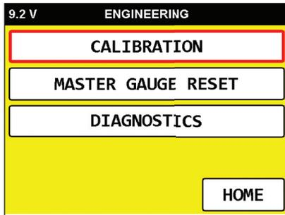
Pulse **FIELD CALIBRATION** en el menú Calibración.
