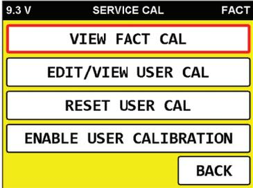
Aquí puede ver las constantes de calibración de fábrica para cada profundidad. Presione la tecla + o — para avanzar a la profundidad deseada como se ve a continuación:
