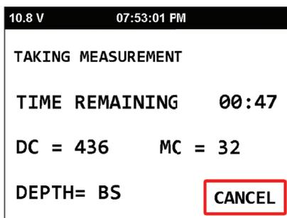
**NOTA:** Si el indicador está en modo de bajo consumo (encendido de la pantalla apagada) al presionar la tecla **MEASURE**, transcurrirá un período de calentamiento de aproximadamente 10 segundos para llevar las señales electrónicas y del tubo detector a un nivel estable antes de que pueda comenzar la medición.
