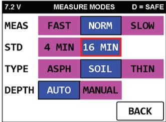
Pulse 16 MIN para cambiar el modo **STANDARD** al modo **ESTADÍSTICO** y pulse el botón **STD/STAT** para saltar al menú **NEW STANDARD** como se muestra a continuación:
