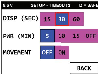
**DISP (SEC)** – Esto establecerá el tiempo de espera en segundos en cuanto a cuándo el densímetro entrará en modo de suspensión. Al presionar cualquier tecla o tocar la pantalla, se volverá a activar.
