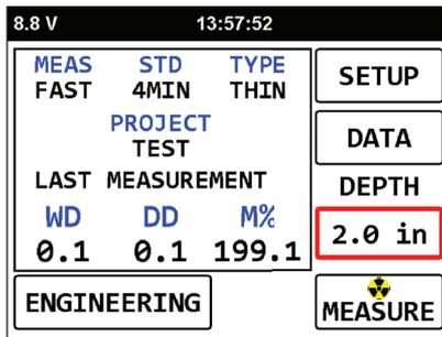
Pulse el valor bajo el botón **DEPTH** 2.0 en la pantalla para seleccionar el grosor deseado para el material que se va a medir.
