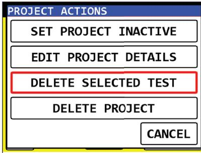
Pulse **DELETE** para eliminar la prueba de campo seleccionada.
