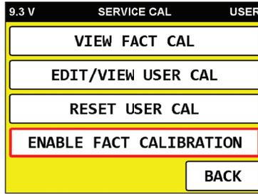
Al presionar RESET USER CAL, se restablecerá la calibración del usuario para que coincida con la calibración de fábrica.
