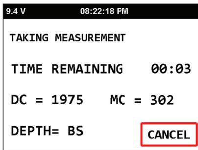
Después de que haya transcurrido el contador **TIEMPO RESTANTE**. La densidad húmeda (WD) y el porcentaje Marshall (%MA) aparecerán en la pantalla. Dado que el canal de humedad está midiendo Hidrógeno, los resultados mostrados se aproximarán al Contenido de Asfalto (AC) de la mezcla. La profundidad de medición será de 100mm (4 pulgadas) o incluso más dependiendo del contenido real de asfalto.
