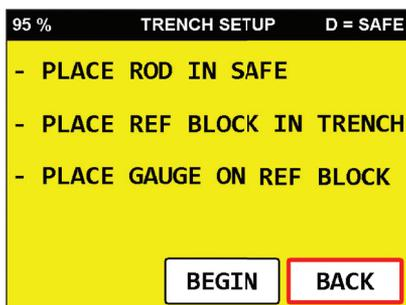
Pulse **BEGIN** para iniciar la **CORRECCIÓN DE TRINCHERA**.
