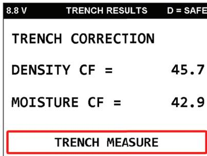
Presione **TRENCH MEASURE** para tomar la medición en la zanja. Una vez completada la medición, el densímetro mostrará los resultados basados en los factores de corrección de zanja.
