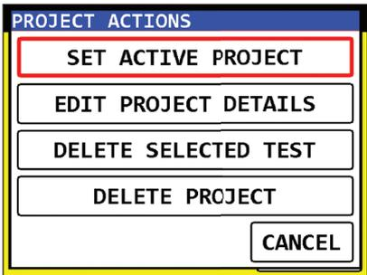
Pulse **SET ACTIVE PROJECT** para activar el registro del proyecto para almacenar los datos de medición en la carpeta del proyecto.
