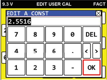
Para que la Calibración del usuario surta efecto, debe habilitar la nueva Calibración de usuario.
