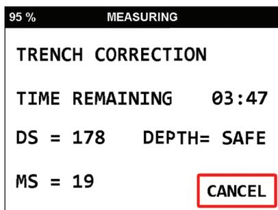
Se inicia un conteo de cuatro minutos indicando que se está determinando una corrección para dar cuenta del agua en las paredes de la zanja. Se utilizan cuatro minutos para producir una precisión suficiente para determinar el valor; de lo contrario, el factor de corrección puede producir un error mayor que el error de zanja.
