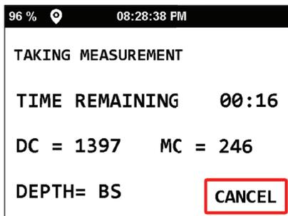
Después de que haya transcurrido el contador **TIEMPO RESTANTE**. La densidad seca (DD), la densidad húmeda (WD), el porcentaje de humedad (% M), la densidad húmeda (WD), el contenido de humedad (M) y el porcentaje de proctor (%PR) aparecerán en la pantalla.
