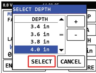
Usando las teclas + o - en la pantalla, seleccione la profundidad deseada y presione Select para aceptar.
