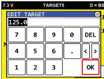
Pulse **OK** en la pantalla cuando haya introducido el valor de destino deseado. Presione el botón **BACK** en la siguiente pantalla para guardar los cambios.
