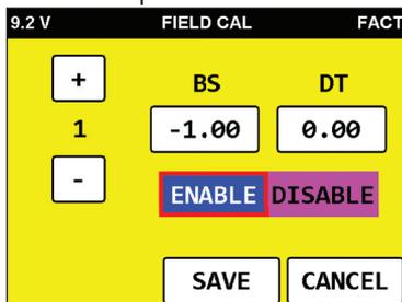
Pulse **SAVE** para almacenar la Calibración de campo.
