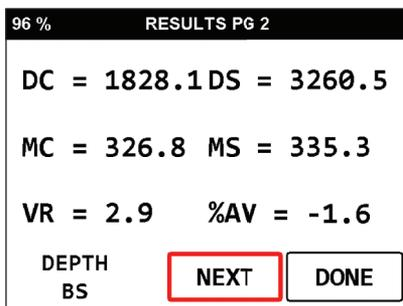
Al presionar **NEXT** de nuevo, volverá a pasar por los menús de resultados de datos. Los recuentos de densidad (DC), el estándar de densidad (DS), el estándar de humedad (MS) y los recuentos de humedad (MC) indicarán los recuentos utilizados para determinar los datos calculados.
